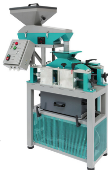
Дробилка валковая ДВГ 200х125 с питателем ПГ1
